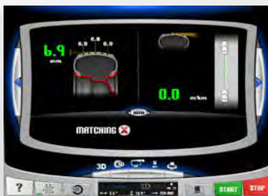
Głębokość bieżnika oraz ścięcie opony
