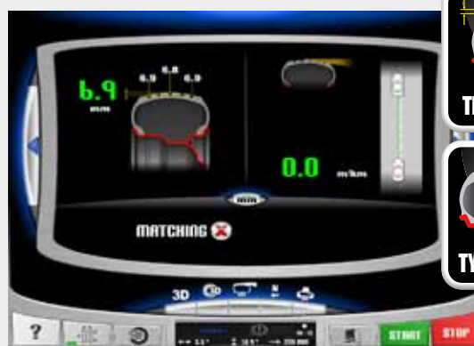
Głębokość bieżnika oraz ścięcie opony
