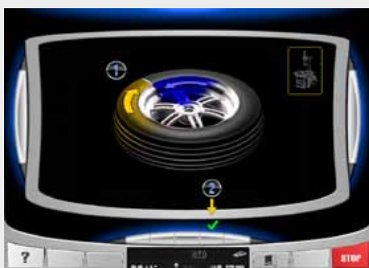
Pomiar bicia we wszystkich płaszczyznach
