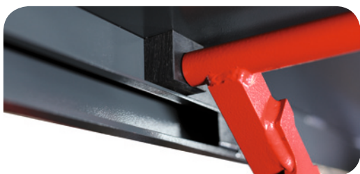
Rampy i rama podnośnika wyposażone w bezobslugowe ślizgi smarowane automatycznie
