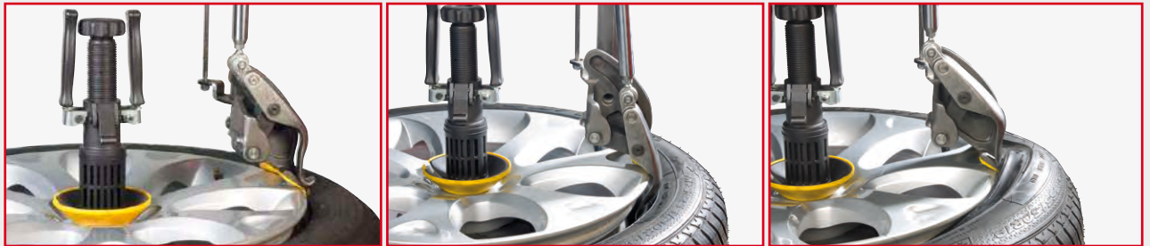
Procedura demontażu górnej stopki opony
