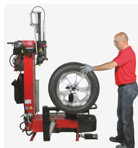
Ergonomiczny podnośnik koła pozwala na łatwe pozycjonowanie koła na stole montażowym.
